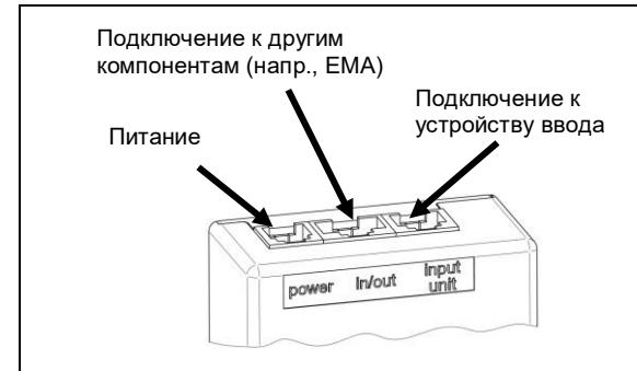
Рисунок 4: Порты в корпусе замка
