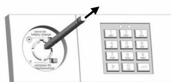
Рис. 5.3: Выньте шестигранный ключ и квадратный вал.
